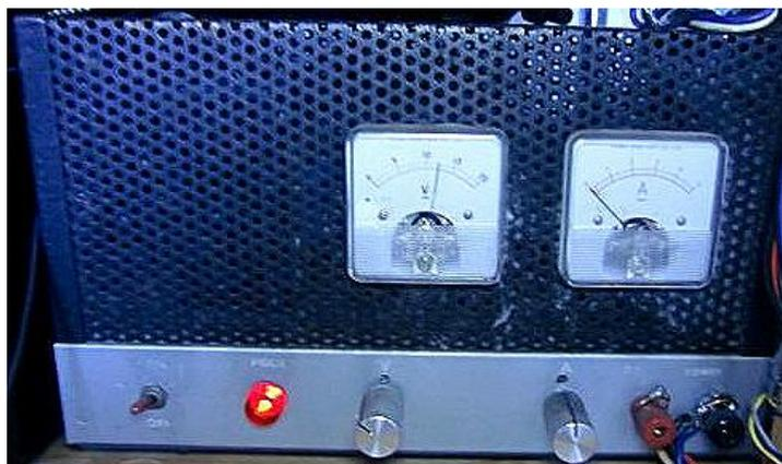
電源コントロール部は秋月電子の安定化電源ユニットを使用して、FT-817の電源やバッテリーの充電器として使用しています。
