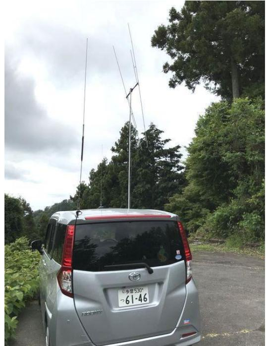
電波伝搬実験終了後、HB9CVを水平にして、移動運用をすべくテスト電波をだすと、PTTを押すとRIGのP OW計が振り切る異常事態はあり、FT-817でモニターすると、何だか発信している様子、HB9CVを水平にした際に、何かしたと思いチェックすると、給電部の半田が外れていました、急速ビニテで補強して、再度チェックすると正常になりました。
