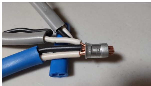
写真# 6 圧着後 (リングに”中”が刻印されている。刻印ミス、被覆噛み込みで欠陥)
