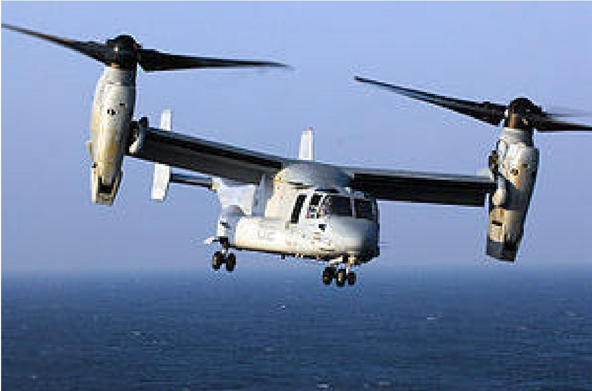
V-22 はアメリカのベル社とボーイング・バートル (現ボーイング・ロータークラフト・システムズ) が共同で開発したティルトローター機 (垂直離着陸、水平飛行両用機)
