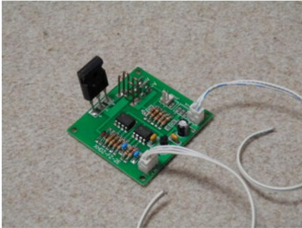
送られたものは写真の小さな基板にパワーMOSFETが実装されている。バラックのまま放熱器をつけてつなぎ込んで動作させてみたところ、しっかりと定電流負荷として動作する。
