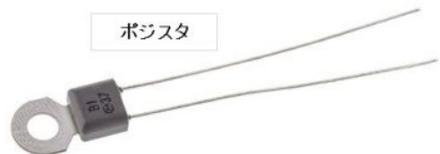
温度が上がると抵抗値が高くなる特性が必要です。電源投入時は温度が低いので抵抗値も低く、大きな電流、といっても 8V で 200mA 程度が短時間(一秒程度)流れ温度が上がります。自己発熱で抵抗値が高くなって、電流が下がり、しばらくすると平衡状態になります。大体 15 秒程度で安定します。温度が安定すれば水晶の周波数も安定するはずです。(これが TCXO の仕掛け
