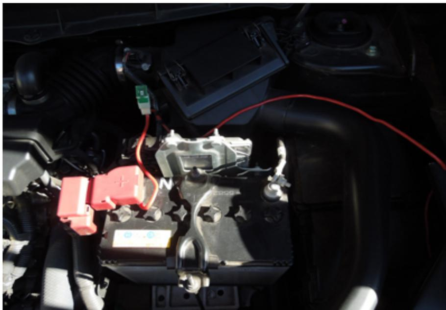
この電源ケーブルは、車のオーディオパワーアンプ等に用いるケーブルで、12V 40A(Max)用です。
