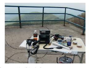
初めに 5/8 G P を設営して、JA1RIZ JA1UPE 各局と通信確認を完了したので、4ele の HB9CV を組立て A N T 切替器を通して設営するが、4ele の HB9CV から電波が出ません V S W R が無限大の為に送信が停止していると、判断して、宍戸 O M が HB9CV の給電部を取外してチェックしましたが、異状有りませんでした。
