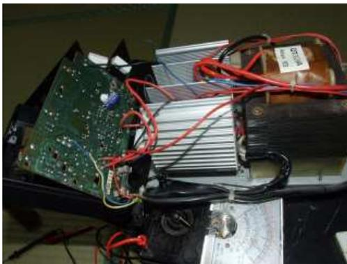
基板の裏側は見えるので、各部の電圧を適当にチェックしていくと、最後の出力部に成ると電圧が出ていません、これは部品が取付けてある表側を確認しないと判りません。
