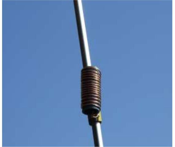
54Mhz 付近に同調しているのですが、18φの塩ビパイプから、20φの塩ビパイプに変更して、ベランダで測定すると、51mhz 付近が 1.2 位で同調点が下がりました次に東大和の「緑地公園」に行って測定すると、52mhz 付近が 1.2 位で同調しています。
