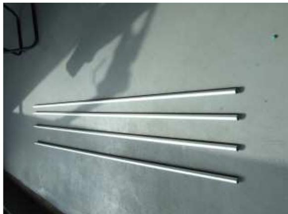
製作は、1m のアルミパイプを 0.9m に4本カットから始めました、次に給電部と短縮コイルの接合部として、2本を更に半分にカットします。カットした、アルミパイプの給電部と短縮コイルの接合部に、カットした塩ビパイプをタップネジで取り付けます。これで、基本エレメントが完成です。
