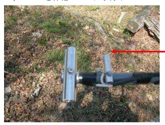
ブームにエレメントを取り付ける前の状態、エレメントクランプ とアルミパイプの一部に切り込みを付けた物にショートバーを 取付ける
