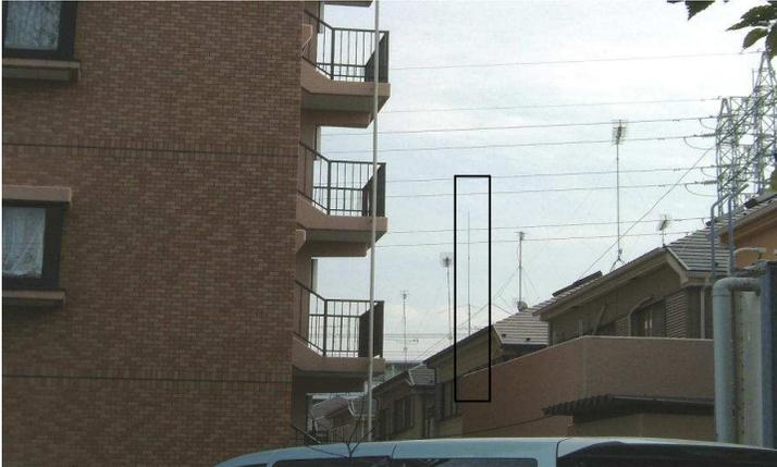
この枠の中に、ちっちゃいアンテナがあります。（短縮型50MHz用 5/8λ：第一電波製F-61）
