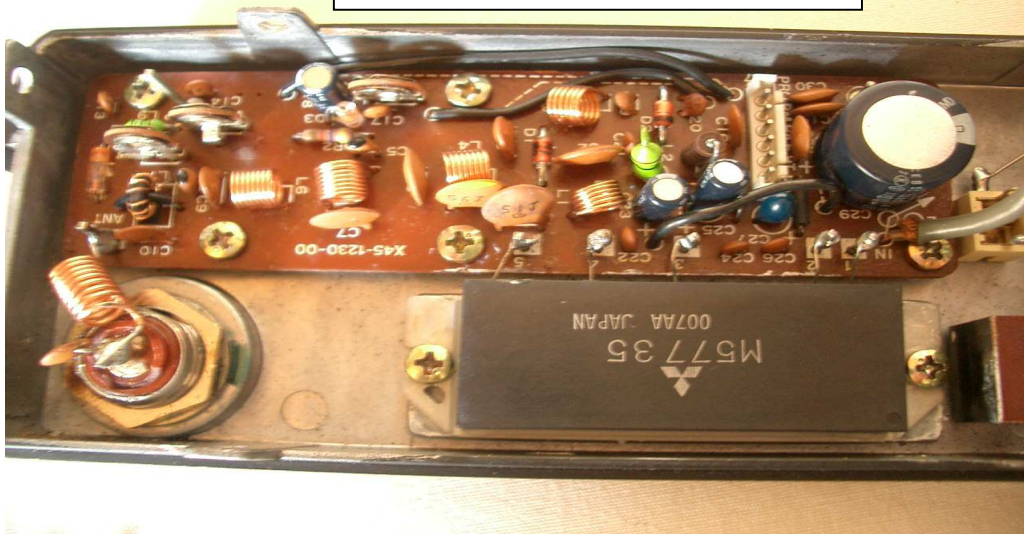
パワーモジュール交換後のファイナル
