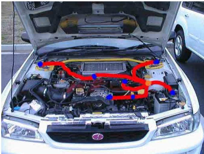
ポイントはバッテリーの「マイナス端子」より、耐熱コード（8mm）等を用いて、エンジンルーム内の「各ポイント」へ配線を実施するだけです。
