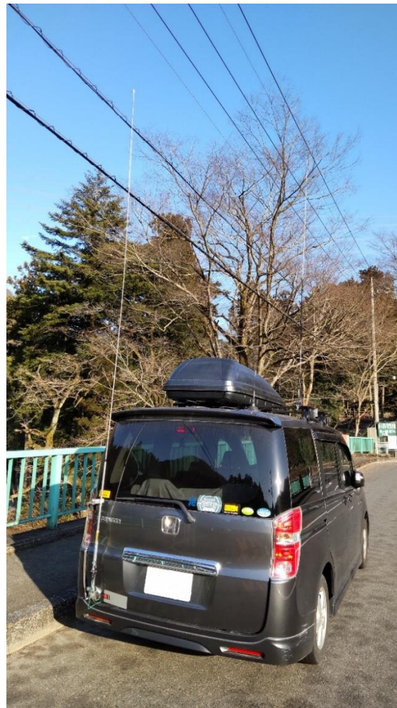
5/8\lambda のロッドアンテナが枝に当たって曲ってきた（要対策）、 1/2\lambda には変化なし。 給電部品、取り付け金具、配線等に欠品、破損、ガタツキなし。試験結果：まずまず
