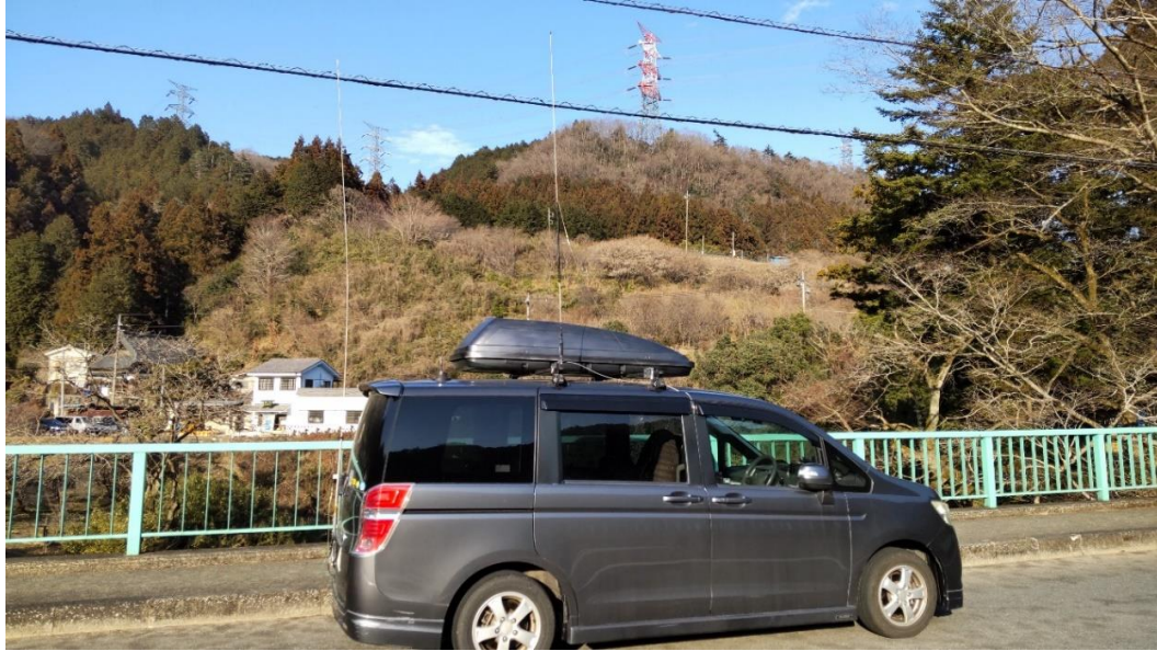
200 キロ超耐久走行試験後の状況（リアが 5/8\lambda 、ルーフが 1/2\lambda ）
