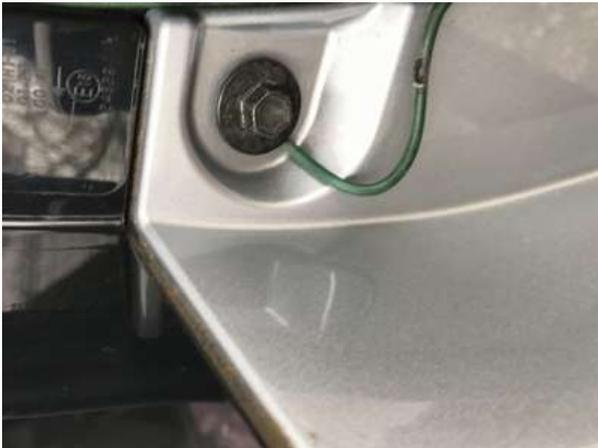
同軸ケーブルの引き込みは、雨水が入らない事と、ケーブルが室内で極力見えない様な引き回しをする様にしました。
