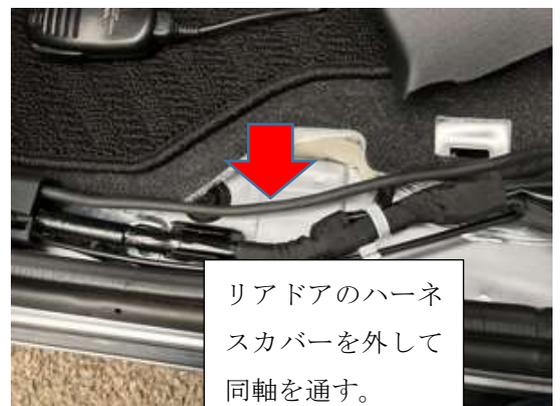
リアドアのハーネスカバーを外して同軸を通す。
