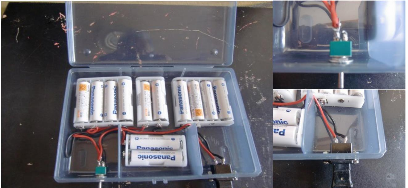
左が電池BOX全体、右上がダイオード電圧調整スイッチ(ダイオードが見えません)右下が電源コネクタ部です。
