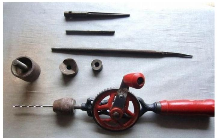
四角い穴を空けるため、ドリルで穴を何個も開けてそれをニッパーやヤスリで切り取り、更にヤスリで成形して、トランスの電源端子がシャーシ内側に出る様にします。
