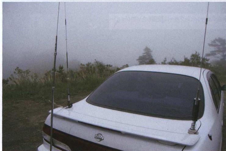
バンパー・マウントに付けた50MHz用 $\frac{1}{4}$ λホイップ、右側は7MHz用、トランクの左側に付いているのは144/430MHz用(WIRESに使用)
